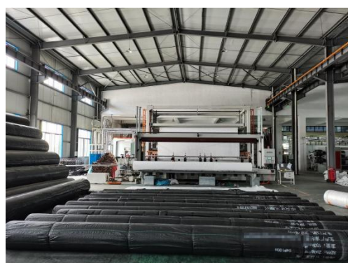
图2 聚酯长丝土工布生产中
