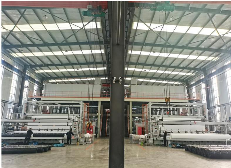
两条年产万吨超级涤纶长丝土工布生产线投产
